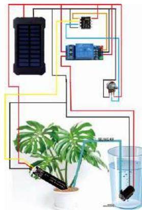
Gambar 7. Desain slat penyiram otomatis berbasis panel surya dan smart sensor
